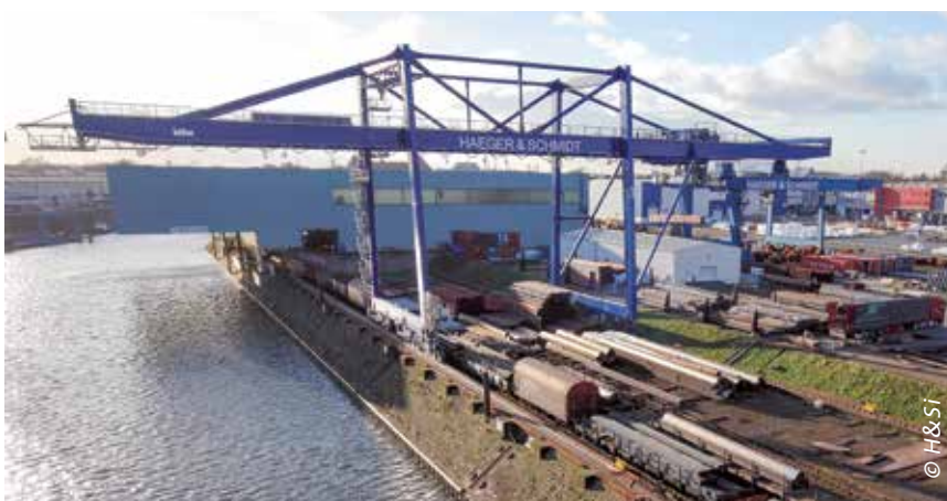
Der Neubau des Kranbauers Künz auf der Duisburger Stahlinsel hat eine um 25 Prozent höhere Tragkraft von 40 Tonnen und ist mit modernster Technik ausgerüstet.
