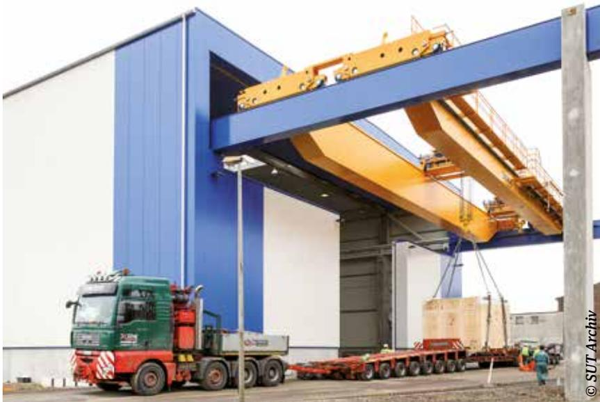
Anlieferung eines 149 Tonnen schweren verpackten Getriebes zum Umschlag beim HTD auf ein Binnenschiff.
