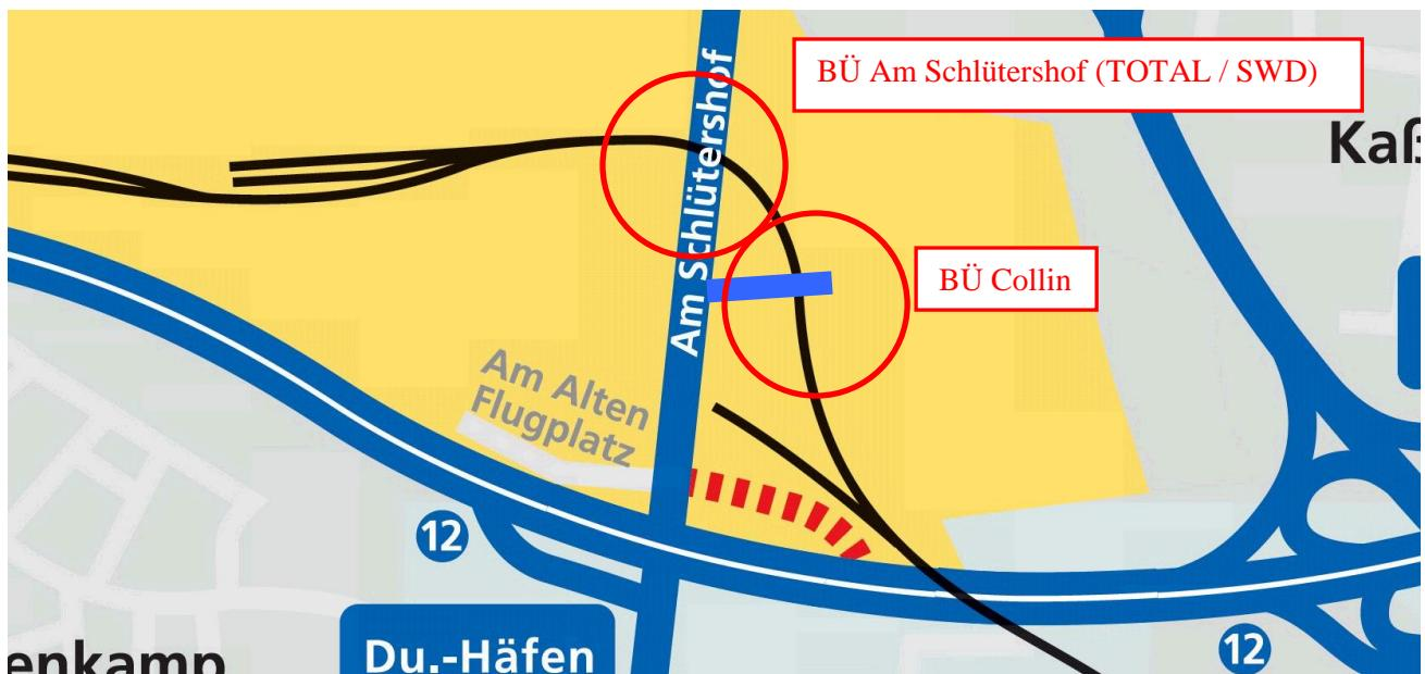
Die Erschließungsstraße zum Industriegelände Collin kreuzt nördlich der Weiche 141 die Gleise 2 und 3 höhengleich. Dort ist als technische Sicherung eine Lichtzeichenanlage mit Halbschranken installiert. Das ordnungsgemäße Arbeiten der BÜ-Sicherung wird durch Überwachungssignale angezeigt.
