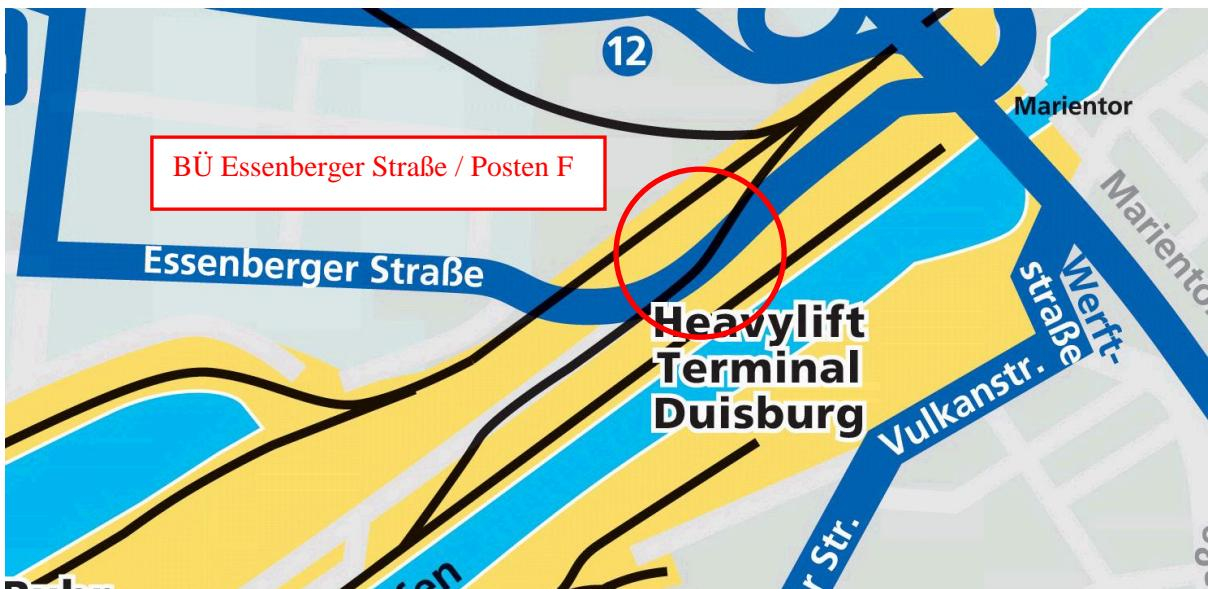
Der mit Lichtzeichen, Halb- und Fußwegschränken (LzH / 2F) technisch gesicherte BÜ Essenberger Straße / Posten F befindet sich zwischen den Weichen 100 und 156 im Zuführungsgleis zum Nordkai des Außenhafens.
